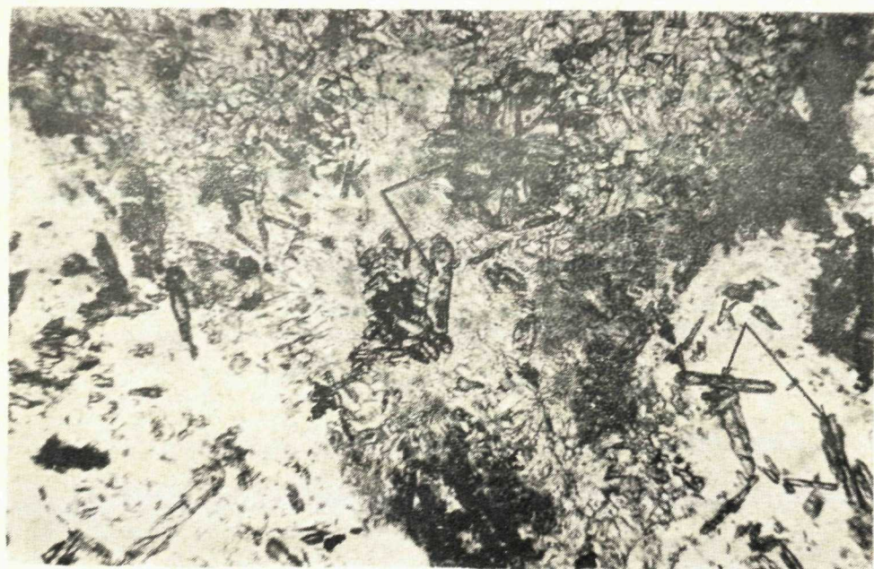
Obr. 4. Detto metasomatit ako na obr. 1. Vidieť hniezdovité zoskupenia vretenovitých a stĺpkovitých kryštáľkov pleochroického korundu. || nikoly, zväčšené 35-krát. K = korund.
